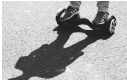
песок и влага могут попасть под корпус на батарею, во время езды, а уже из-за короткого замыкания происходит взрыв или возгорание. Возгорание гироскутера может произойти, если кататься в дождь на модели, у которой нет защиты от влаги и мелких частиц.
